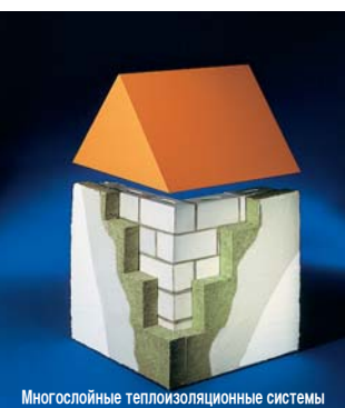
Многослойные теплоизоляционные системы
